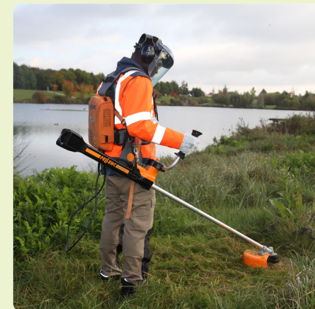
↑ Débroussailluse électrique, France
